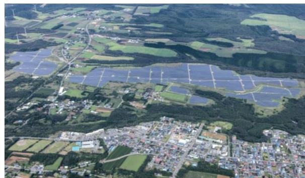
(写真)ユーラス六ヶ所ソーラーパーク(左：鷹架地区、右：千歳平地区) 敷地面積：約253ha 設備容量：115MW
