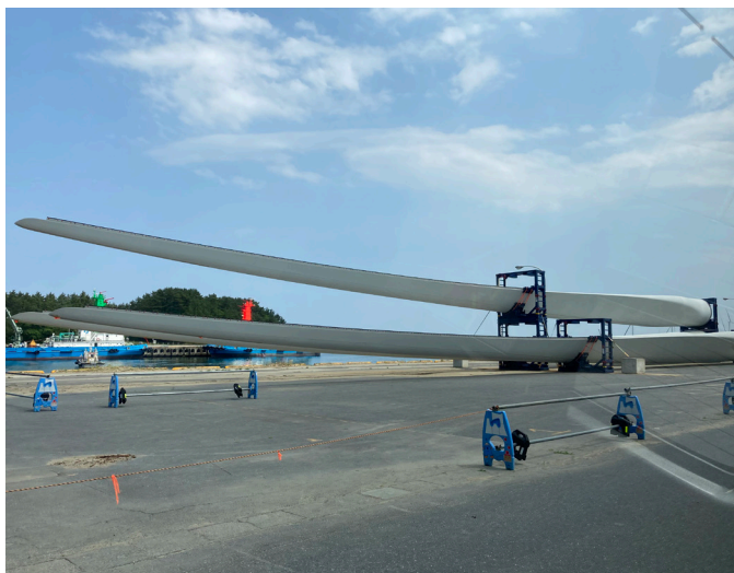
風車のブレード（全長約 64 メートル）
